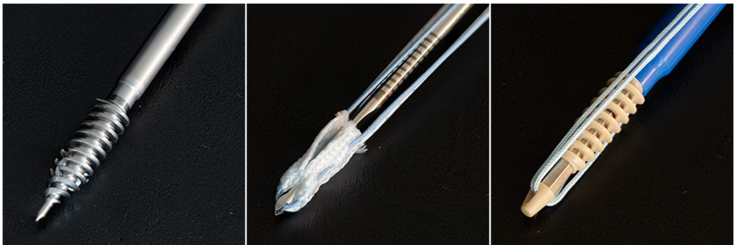
Abbildung. 1: Verwendete Fadenanker in dieser Studie. Von links nach rechts: Titan-Schraubanker, all-suture Anker, knotenloser Anker (jeweils n=10).
